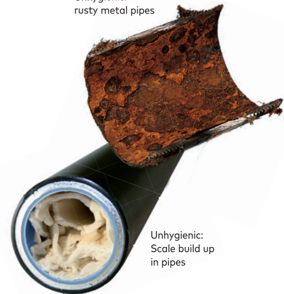
Unhygienic: rusty metal pipes
